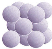
オーステナイト 面心立方構造
